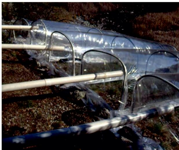
Fig. 12 - Sistema di fumigazione controllata utilizzato nelle prime ricerche scientifiche sull'effetto di elevate concentrazioni di anidride carbonica su specie vegetali.
