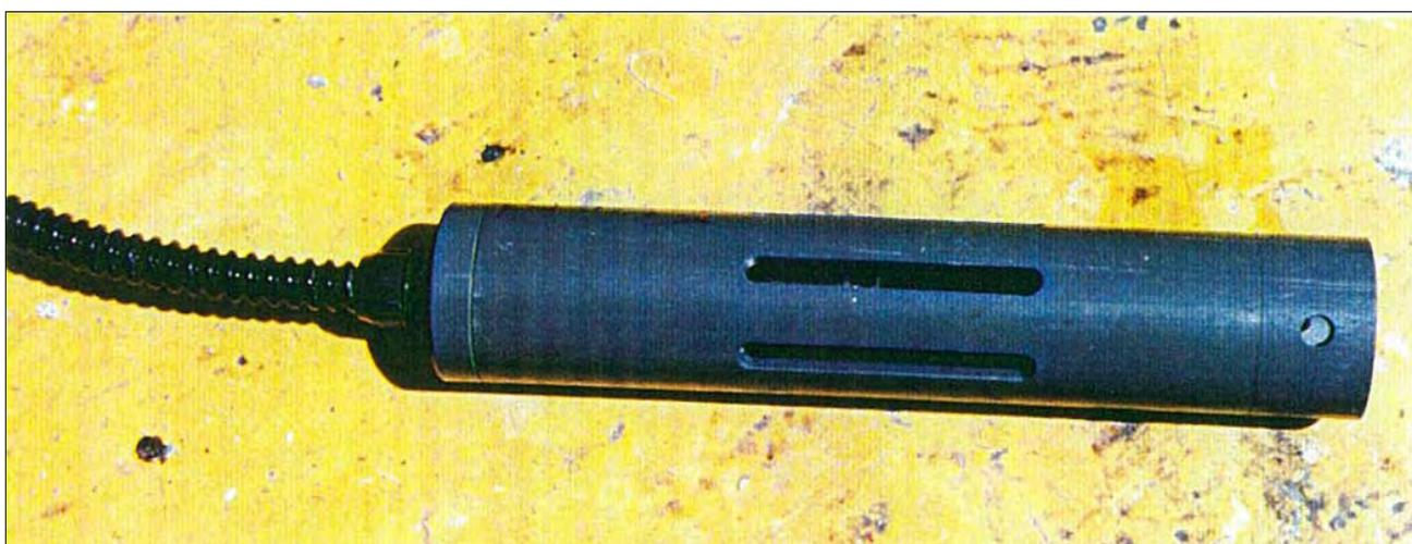
**FOTO 36 - Sonda per la misura della pressione**
