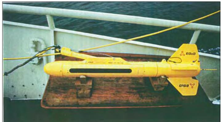
Immagine d'archivio del contenitore stagno idrodinamico che racchiude i dispositivi di emissione e ricezione degli impulsi del Side Scan Sonar, che viene operativamente trainato in prossimità del fondo.
