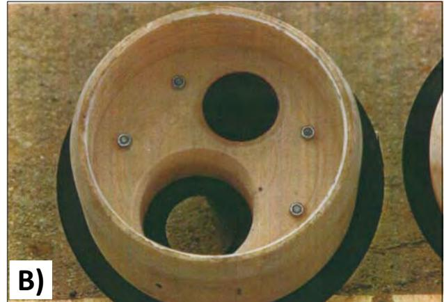
FOTO 9 e 10 - Particolari della testa della "cella" posta in opera nella zona di transizione del pozzo-spia.
