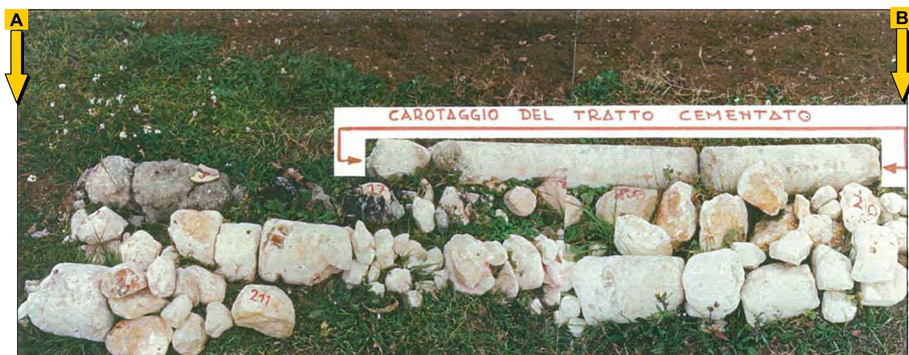
FOTO 14 - Parte del carotaggio recuperato dalla trivellazione del pozzo-spia con evidenziato il carotaggio del tratto cementato e successivamente riperforato
