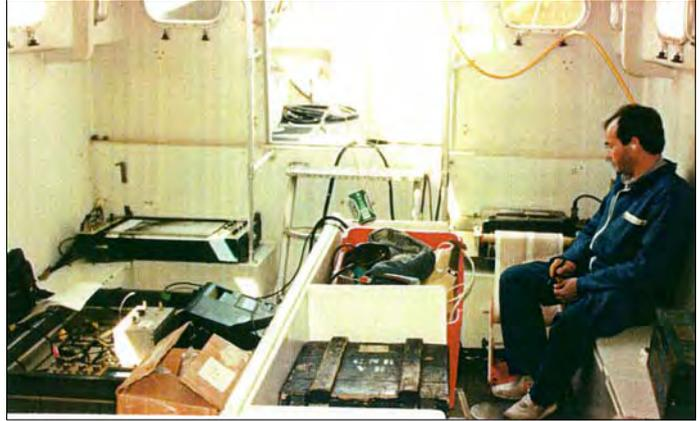
La strumentazione elettronica di elaborazione e registrazione dei sonogrammi è stata installata nell'ampia cabina del mezzo nautico messo a disposizione dalla Marina Militare. Sulla sinistra si nota il registratore EPC 3200 mentre a destra il tecnico controlla il funzionamento del Side Scan Sonar.
