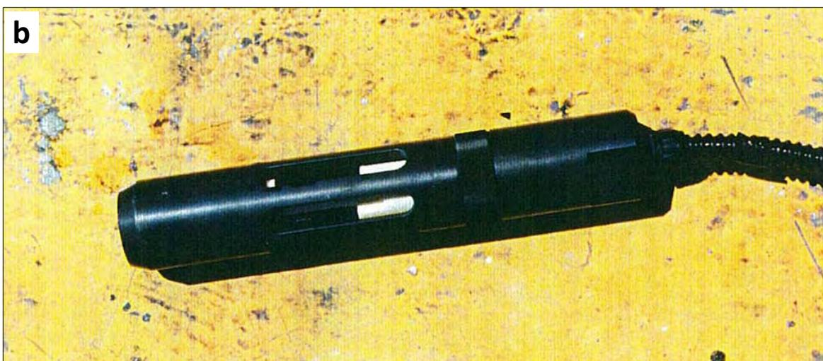
**FOTO 35 - Sonda per la misurazione della temperatura e della salinità
