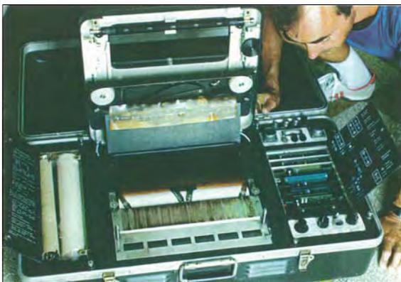
Il complesso registratore grafico a due canali del Side Scan Sonar EG&G, qui ripreso durante le operazioni di controllo e manutenzione, utilizza speciale carta sensibile elettrochimica. Sulla destra si noti il complesso sistema di regolazione dell'elettronica, protetto da un piccolo portello.
