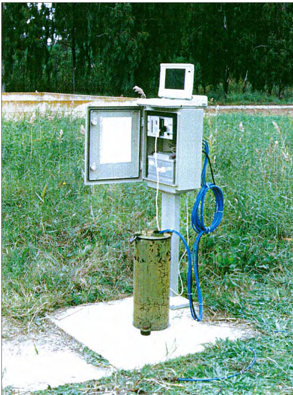
**FOTO 19 - Il sistema di acquisizione e immagazzinamento dati installato sul pozzo-spia "Leggiadrezze"**
