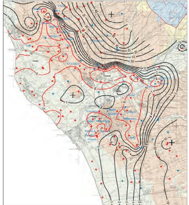
Fig. 10 – Carta delle isopieze (m s.l.m.) di maggio-giugno 1998 (da GRASSI et alii, 2000).
