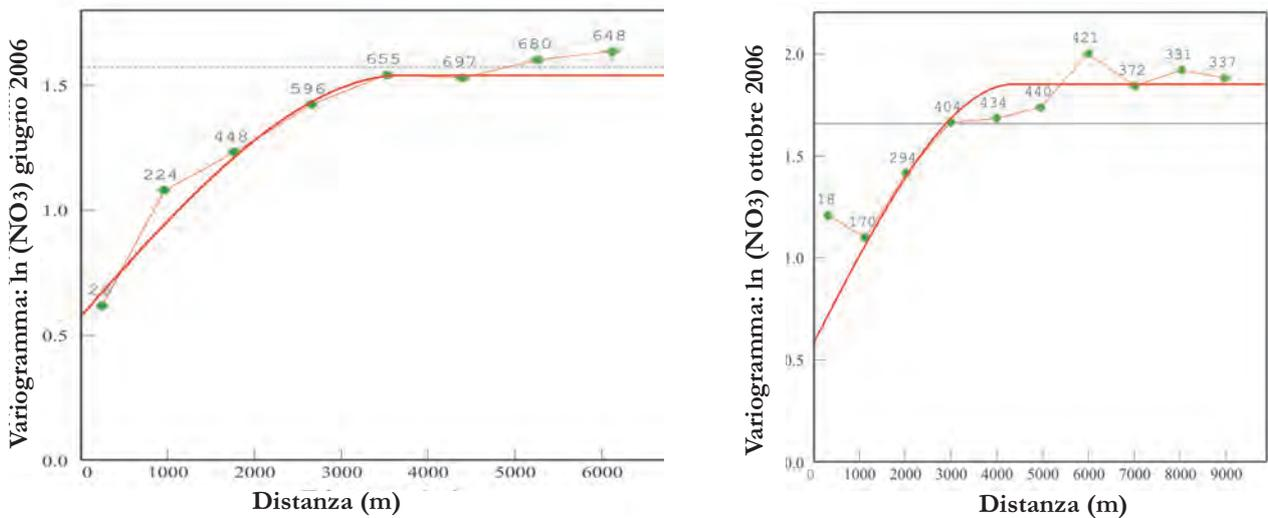
Fig. 63 – Variogramma omnidirezionale per i logaritmi naturali delle concentrazioni di  $\text{NO}_3$  nel Giugno e nell’Ottobre 2006 per le acque dei CISS 32CT010+32CT030. La linea spezzata rappresenta il *trend* del variogramma sperimentale, i numeri associati ai punti verdi si riferiscono al numero di coppie trovato ad ogni lag (870 m nel Giugno 2006) e (1000 m nell’Ottobre 2006), mentre la linea rossa continua rappresenta il modello matematico scelto.
