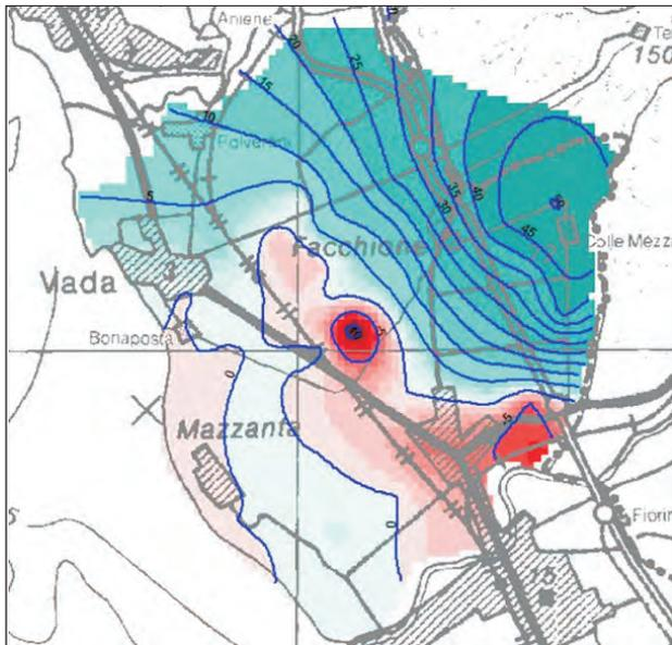
Fig. 12 – Isoipse (m s.l.m.) della superficie piezometrica media annua del periodo 1999-2000 (da ARPAT, 2003).
