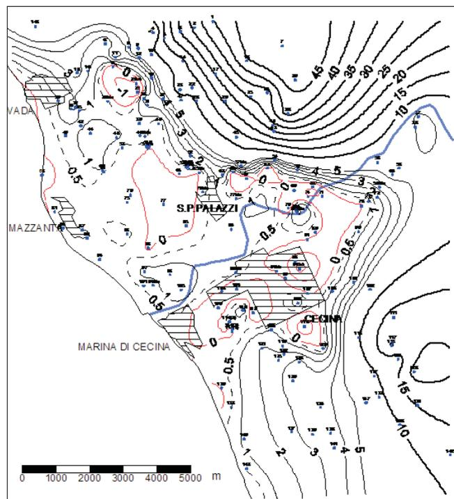
Fig. 14 – Situazione piezometrica (m s.l.m.) di ottobre 2001 nell'area Vada-Cecina (da PRANZINI, 2004a – elaborazione da dati ASA).
