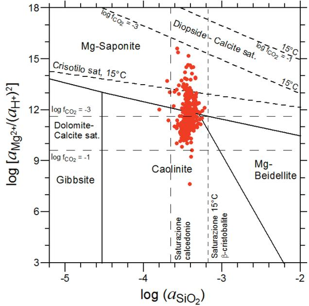
Fig. 53 – Diagramma di attività per il sistema MgO-SiO<sub>2</sub>-Al<sub>2</sub>O<sub>3</sub>-H<sub>2</sub>O, in cui sono rappresentate le acque dei CISS 32CT010+32CT030 e 32CT050. I limiti di stabilità per le fasi solide e le linee di saturazione rispetto a minerali di interesse si riferiscono a 15°C, 1.013 bar.
