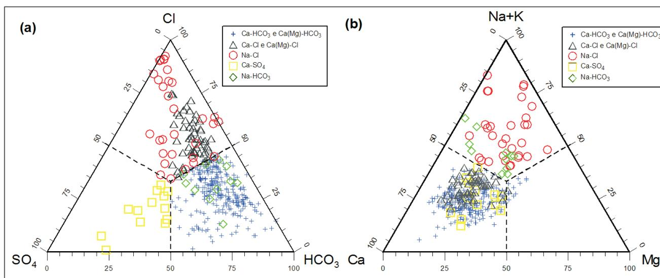
Fig. 22 – Diagrammi triangolari (a) HCO<sub>3</sub>-Cl-SO<sub>4</sub> e (b) Ca-Mg-(Na+K) per le acque dei CISS 32CT010+32CT030 e 32CT050.
