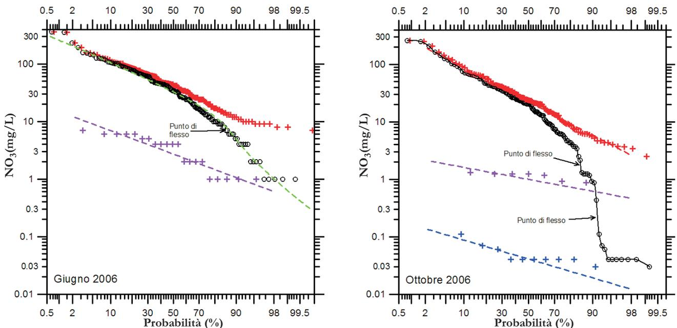
Fig. 58 – Diagrammi di probabilità per la concentrazione (in mg/L) di  $\text{NO}_3$  nel Giugno e nell'Ottobre 2006 per le acque dei CISS 32CT010+32CT030 e 32CT050. I circoli neri definiscono la distribuzione cumulativa dei valori misurati. Le croci e le linee di colore rosso, viola e blu si riferiscono alle singole popolazioni ottenute mediante la procedura di *partitioning* di Sinclair (1974).
