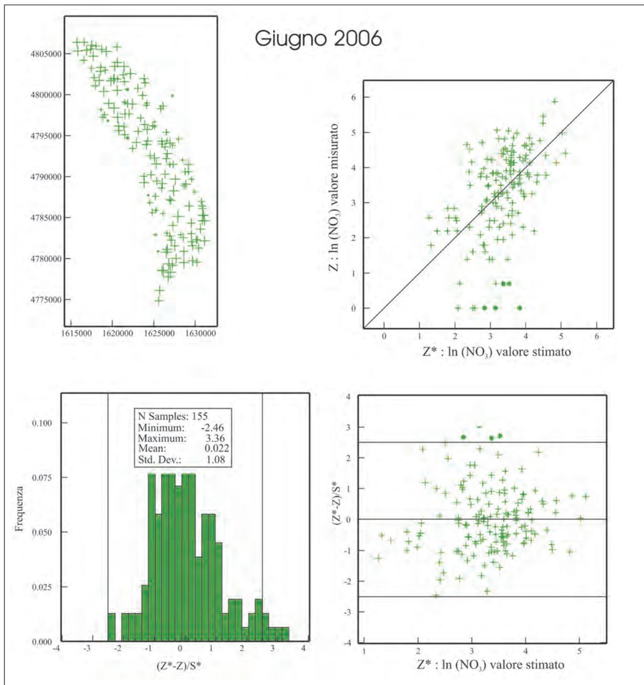
Fig. 64 – Validazione incrociata del modello matematico scelto come rappresentativo del variogramma sperimentale per i logaritmi naturali delle concentrazioni (in mg/L) di NO<sub>3</sub> nel Giugno 2006 per le acque dei CISS 32CT010+32CT030 e 32CT050. I cerchi pieni verdi rappresentano le misure considerate anomale.
