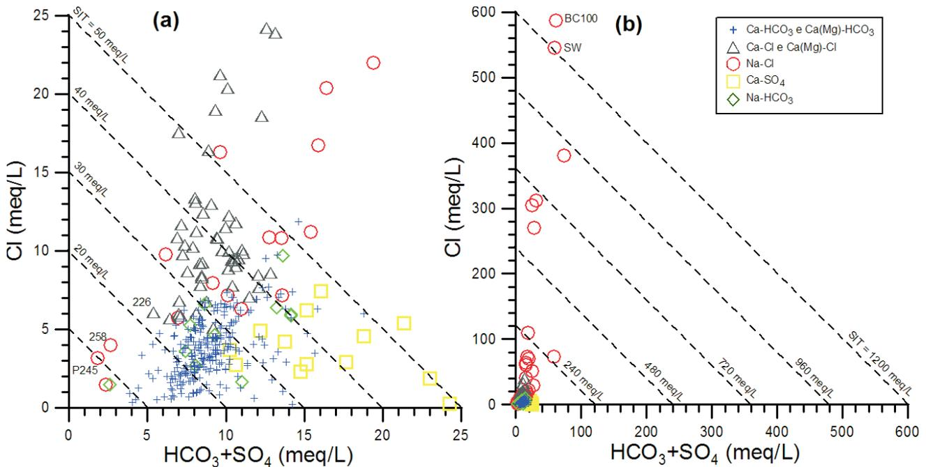
Fig. 24 – Diagrammi di correlazione Cl vs.  $\text{HCO}_3 + \text{SO}_4$  per differenti intervalli di salinità,  $< 50$  meq/L in (a) e  $< 1200$  meq/L in (b), per le acque dei CISS 32CT010+32CT030 e 32CT050.
