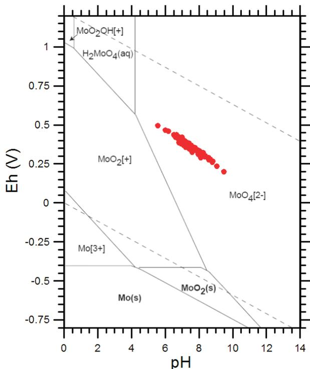
Fig. 34 – Diagramma Eh-pH relativo al sistema Mo-H-O per le acque dei CISS 32CT010+32CT030 e 32CT050.
