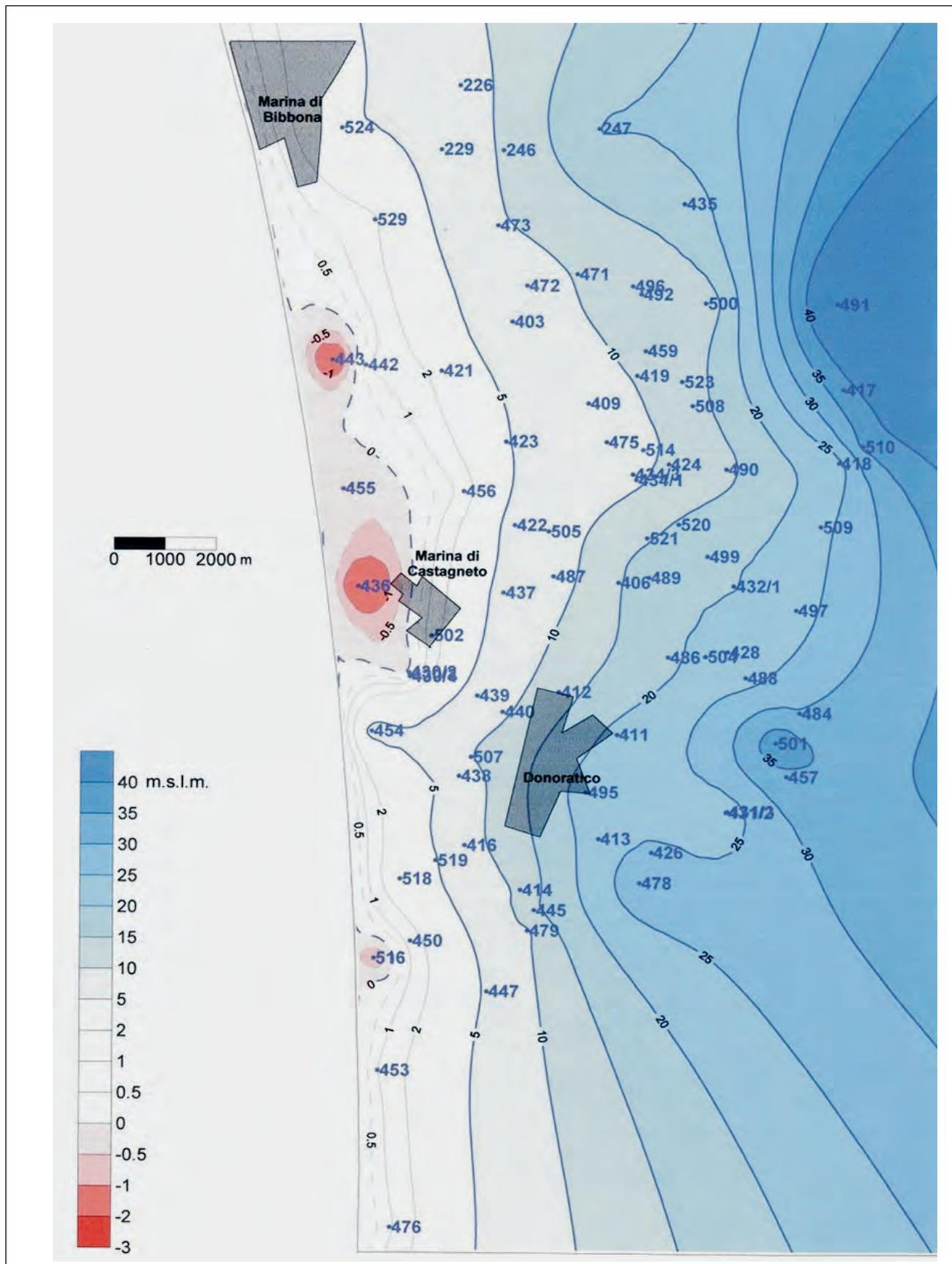
Fig. 18 – Situazione piezometrica di maggio 2001 nell'area fra Marina di Bibbona e San Vincenzo (da PRANZINI, 2004a - elaborazione da dati ASA).
