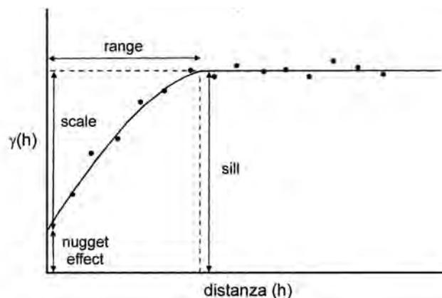
Fig. 56 – Il variogramma modello e le sue principali componenti.
