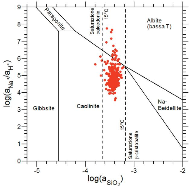
Fig. 54 – Diagramma di attività per il sistema Na<sub>2</sub>O-SiO<sub>2</sub>-Al<sub>2</sub>O<sub>3</sub>-H<sub>2</sub>O, in cui sono rappresentate le acque dei CISS 32CT010+32CT030 e 32CT050. I limiti di stabilità per le fasi solide e le linee di saturazione rispetto a minerali di interesse si riferiscono a 15°C, 1.013 bar.
