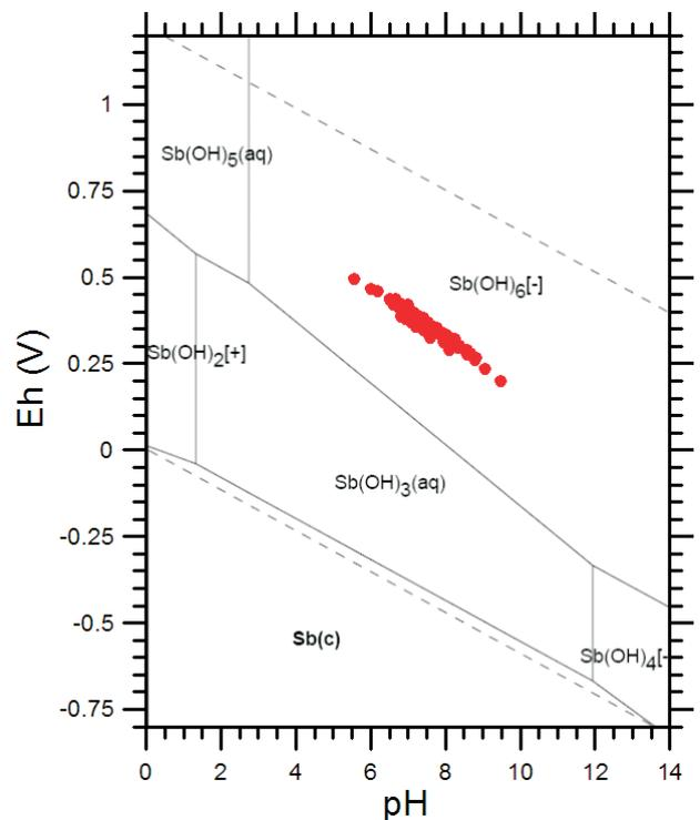
Fig. 37 – Diagramma Eh-pH relativo al sistema Sb-H-O per le acque dei CISS 32CT010+32CT030 e 32CT050.
