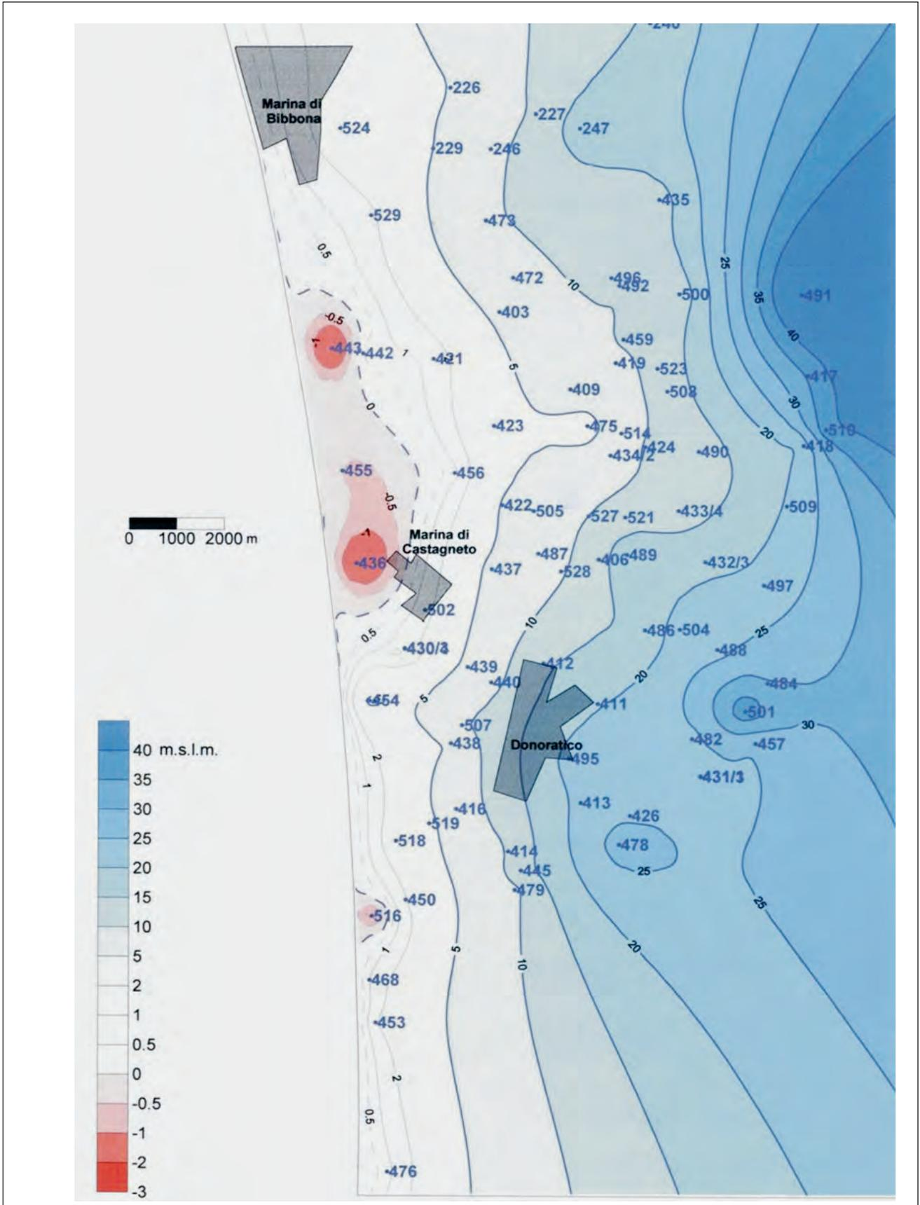
Fig. 19 – Situazione piezometrica di ottobre 2001 nell’area fra Marina di Bibbona e San Vincenzo (da PRANZINI, 2004a - elaborazione da dati ASA).
