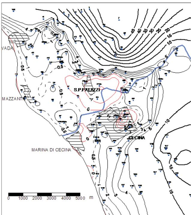
Fig. 13 – Situazione piezometrica (m s.l.m.) del giugno 2001 nell'area Vada-Cecina (da PRANZINI, 2004a – elaborazione da dati ASA).
