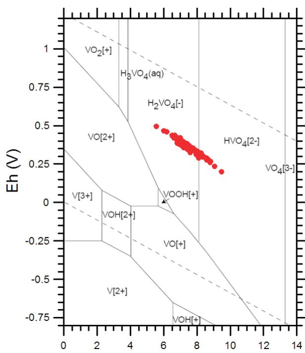
Fig. 41 - Diagramma Eh-pH relativo al sistema V-H-O per le acque dei CISS 32CT010+32CT030 e 32CT050.
