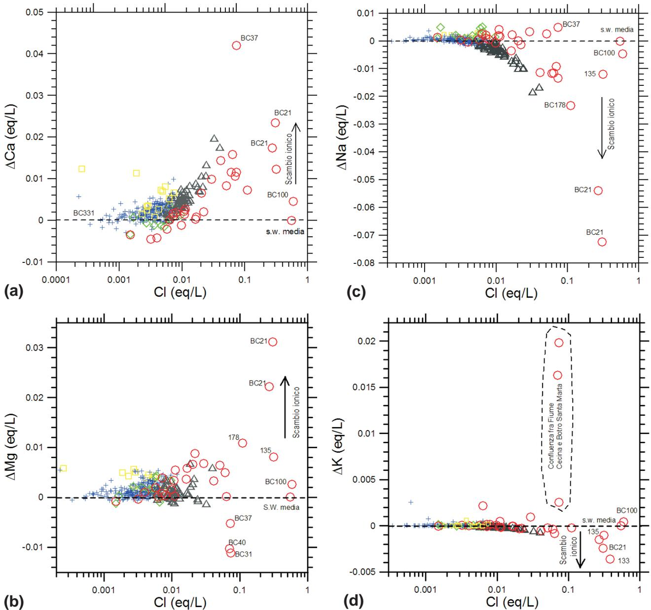
Fig. 26 – Diagrammi di correlazione semilogaritmici fra cloruro e  $\Delta\text{Ca}$  (a),  $\Delta\text{Mg}$  (b),  $\Delta\text{Na}$  (c) e (d)  $\Delta\text{K}$ , per le acque dei CISS 32CT010+32CT030 e 32CT050; la linea tratteggiata per  $\Delta\text{Cl} = 0$  corrisponde alla linea di miscela fra l'acqua di mare media mondiale e l'acqua di falda, rappresentata dal campione BC331.
