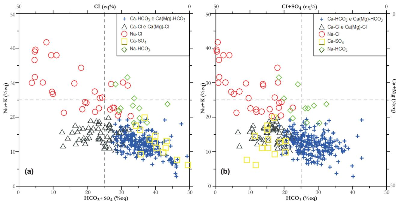
Fig. 23 – Diagrammi quadrangolari di Langelier-Ludwig (1942) con (a) lo ione  $\text{Cl}^-$  e (b) lo ione  $\text{HCO}_3^-$  come anioni singoli per le acque dei CISS32CT010+32CT030 e 32CT050.
