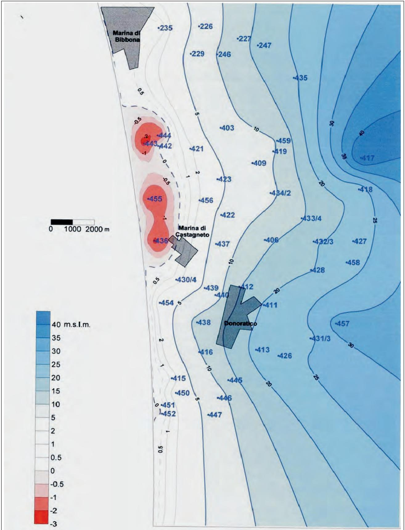
Fig. 15 – Situazione piezometrica (m s.l.m.) di ottobre 1996 nell'area fra Marina di Bibbona e San Vincenzo (da PRANZINI, 2004a - elaborazione da dati ASA).
