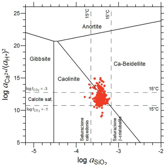
Fig. 52 – Diagramma di attività per il sistema CaO-SiO<sub>2</sub>-Al<sub>2</sub>O<sub>3</sub>-H<sub>2</sub>O in cui sono rappresentate le acque dei CISS 32CT010+32CT030 e 32CT050. I limiti di stabilità per le fasi solide e le linee di saturazione rispetto a minerali di interesse si riferiscono a 15 °C, 1.013 bar.
