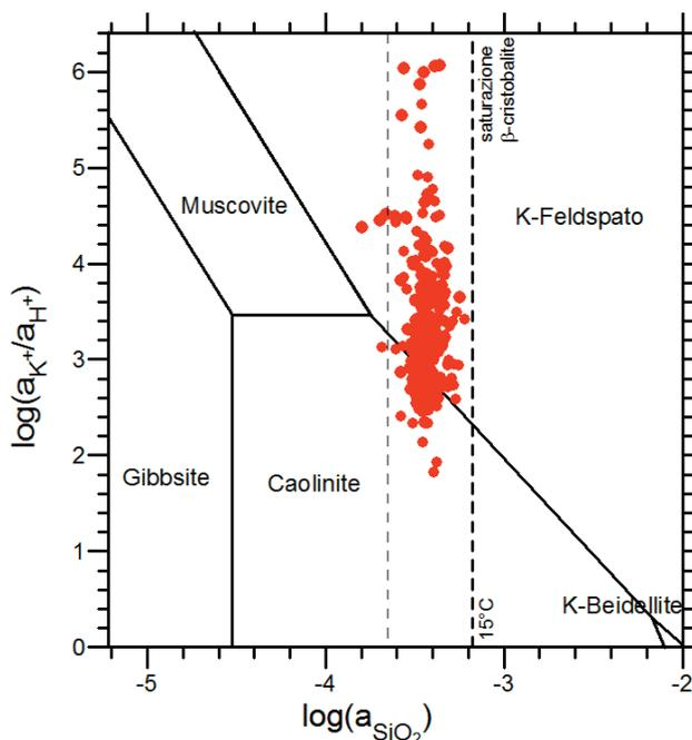
Fig. 55 – Diagramma di attività per il sistema  $K_2O-SiO_2-Al_2O_3-H_2O$ , in cui sono rappresentate le acque dei CISS 32CT010+32CT030 e 32CT050. I limiti di stabilità per le fasi solide e le linee di saturazione rispetto a minerali di interesse si riferiscono a 15°C, 1.013 bar.
