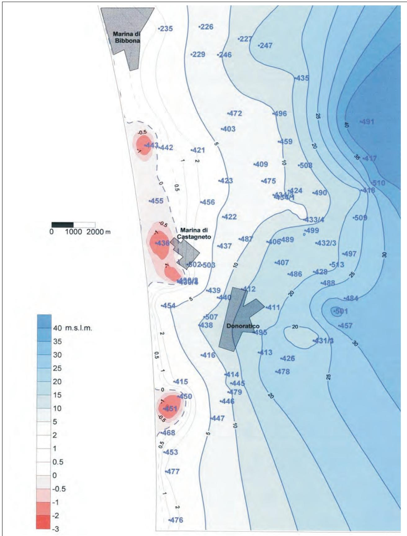
Fig. 16 – Situazione piezometrica (m s.l.m.) di maggio 2000 nell'area fra Marina di Bibbona e San Vincenzo (da PRANZINI, 2004a - elaborazione da dati ASA).
