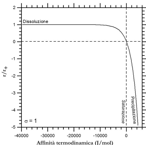
Fig. 43 - Variazione del rapporto  $r/r_+$  con l'affinità termodinamica (da OELKERS, 2001).
