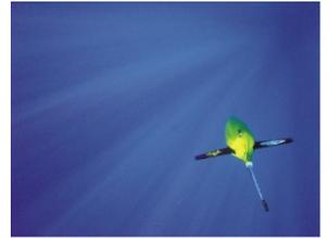
Il primo *glider* dell'OGS, dotato di sensori per la temperatura, la salinità, l'ossigeno disciolto, la clorofilla e la torbidità è stato utilizzato in diverse missioni in collaborazione con enti europei e statunitensi.
