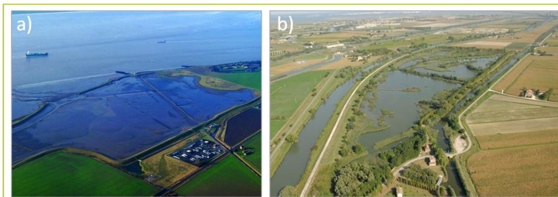
Figura 2. Esempi di due tipologie di aree umide ricostruite: a) area umida costiera salmastra (managed realignment) nel Humber estuary, UK (Fonte: [Tide Project](#)); b) area umida d'acqua dolce a Ca' di Mezzo, realizzata lungo il fiume Bacchiglione, Veneto (Fonte: [ANBI Veneto](#))
