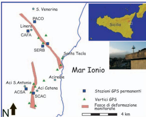
Nel caso del monitoraggio di aree intensamente urbanizzate e interessate da strutture tettoniche attive, quale ad esempio le pendici del versante orientale Etno (Figura 3), la metodologia GPS (Global Positioning System) costituisce un efficace metodo di rilievo per la determinazione e lo studio di movimenti del suolo. Essa ha il vantaggio di non richiedere la visibilità diretta tra stazioni e di poter essere usata anche in condizioni meteorologiche
