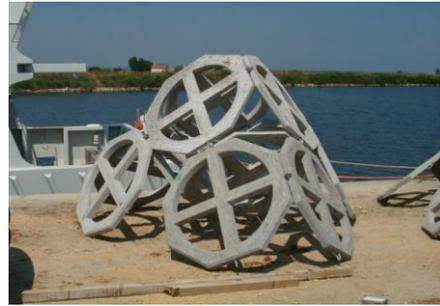
*Figura 2.3b Foto delle Barriere artificiali TECNOREEF® impiegate nello studio: Tipo 2 (a sx) e 3 (a dx).*
