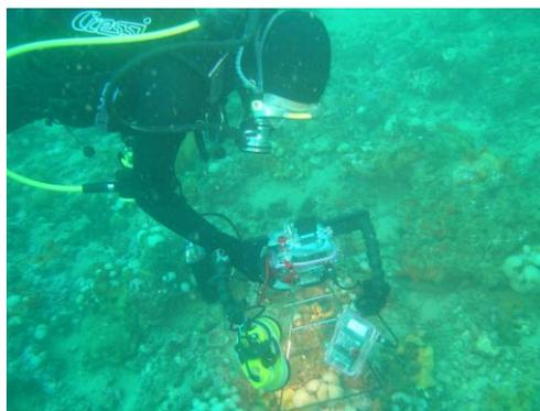
*Figura 2.13 Esempio di sistema fotografico digitale: Olympus C-7070 in custodia impermeabile, con riquadratore e luce mista fari alogeni e flash TTL.*
