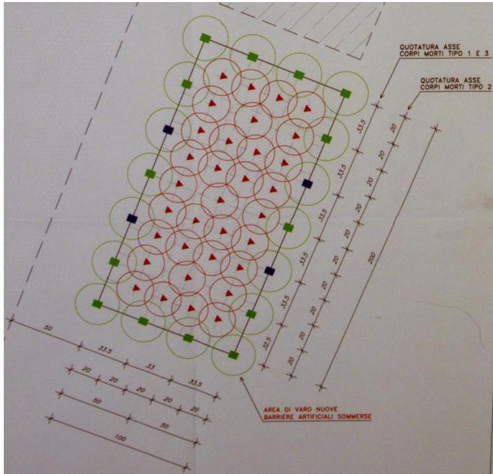
*Figura 2.8 Prima area di posa nell'ambito del Progetto per la gestione dell'allestimento di barriere artificiali sommerse (L.R. n. 15/2007). I cerchi riportano l'ipotetica area di influenza di ogni manufatto.*
