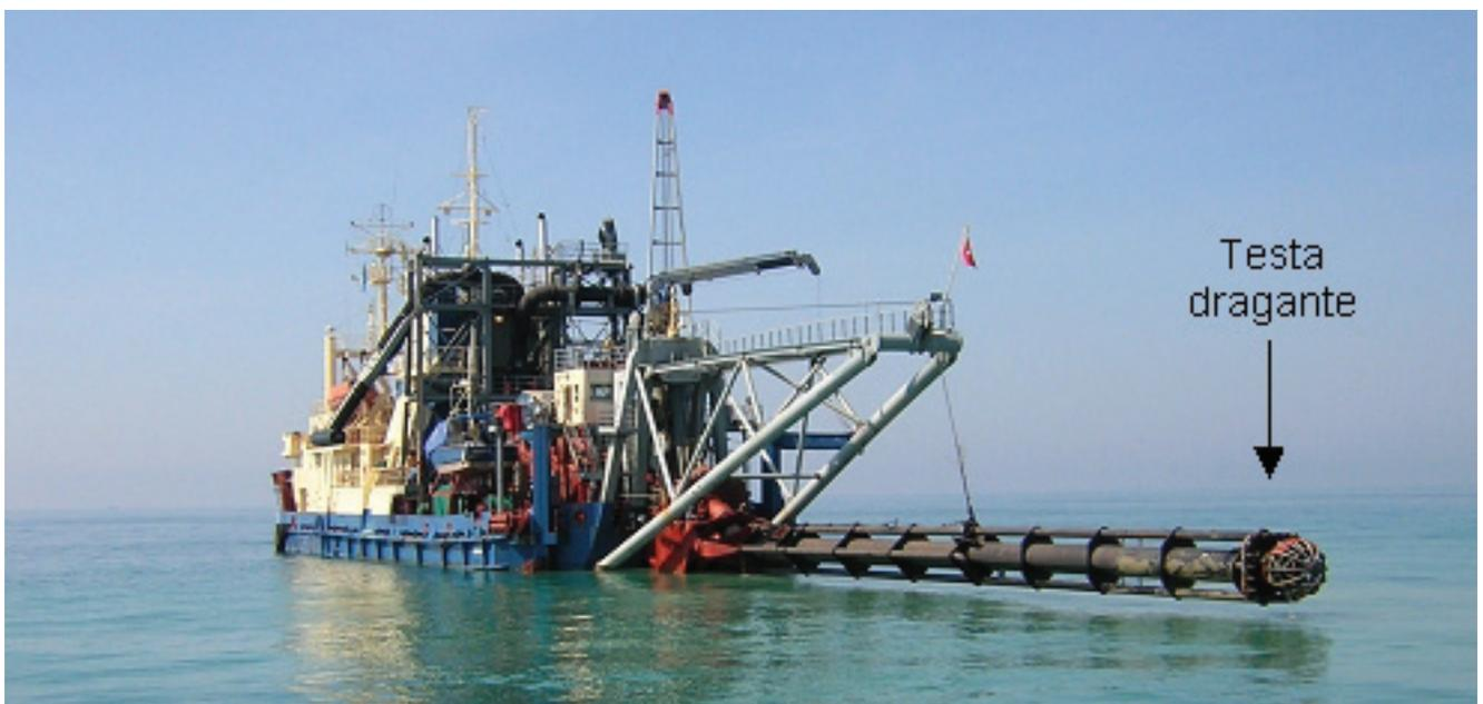
Figura1.4 - Draga stazionaria con l'elinda in superficie; all'estremità dell'elinda è ben visibile la testa dragante.
