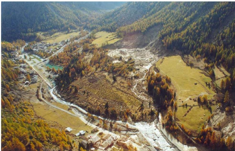
Figura 6.15 Esempio di frana di scivolamento (Cogne, PIFF 007-20387-00).
