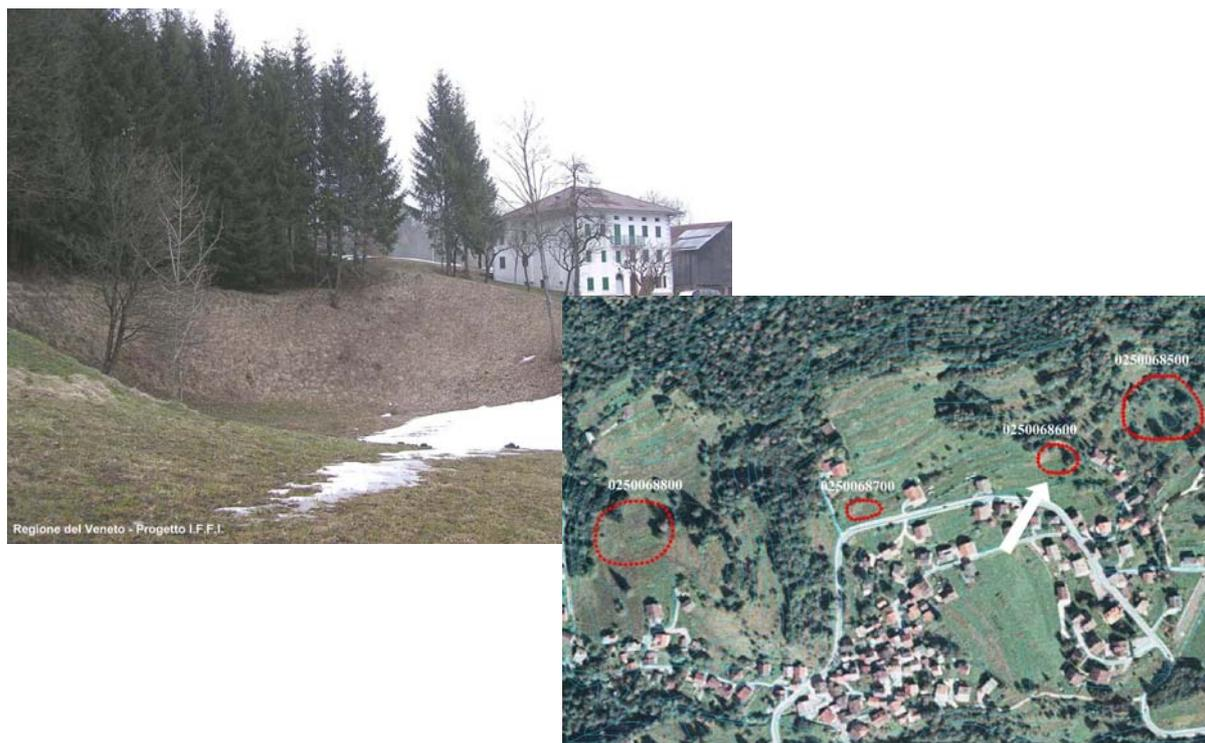
Figura 10.15 Localizzazione su foto aerea di alcuni fenomeni di sprofondamento lento e particolare di uno di essi, Voltago Agordino (BL).
