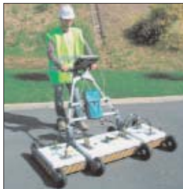
Fig. 5: Apparecchiatura Georadar per la mappatura dei sottoservizi
