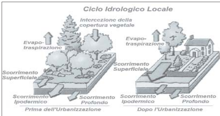
Fig. 1 - Bilancio idrologico di un'area prima e dopo l'insediamento urbano Fonte: Acque di Prima Pioggia da insediamenti produttivi [Grillo e Signoretti, 2004]
