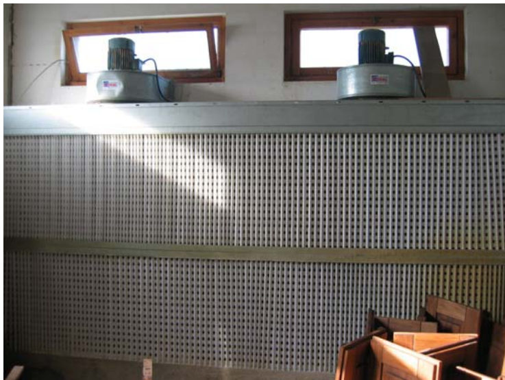
Figura 7: Cabina di verniciatura a secco presso una falegnameria valdostana
