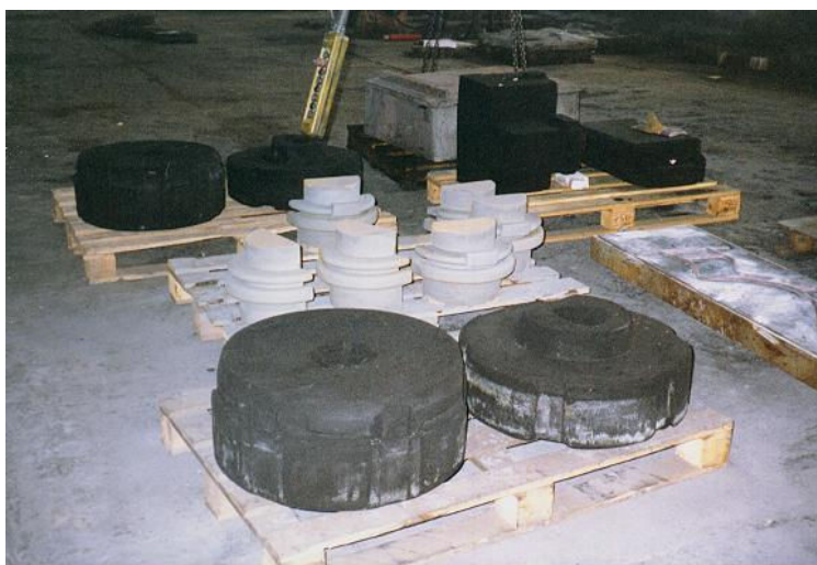
Foto 2.1.11 Anime di varie dimensioni appoggiate su pancali di legno per la loro movimentazione con il carrello elevatore.
