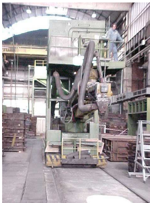
Foto 2.1.7: Carro su rotaia (chiamato in gergo cammello) con braccio mobile per riempimento delle staffe grandi con terra di fonderia nel reparto di formatura manuale (in posizione di scarico nelle staffe, con operatore a bordo).
