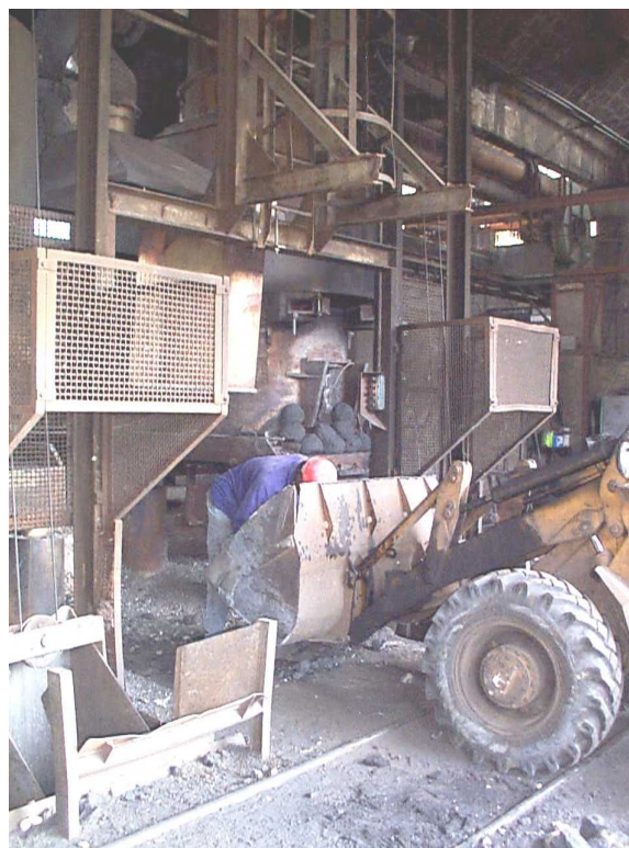
Foto 2.1.22 Rifacimento quotidiano del refrattario del cubilotto: un addetto preleva dalla pala meccanica la terra refrattaria facendone delle palle con le mani e le porge ad un altro addetto che si trova dentro il cubilotto.
