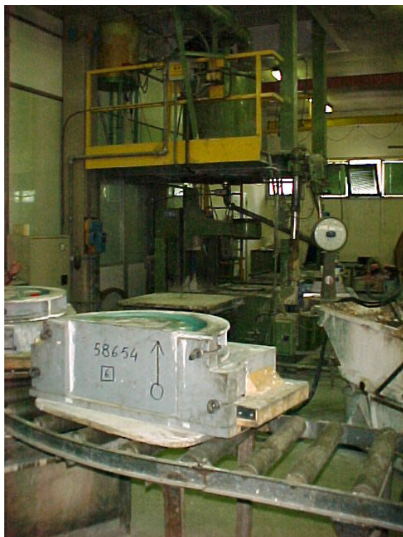
Foto 2.1.10 Reparto formatura anime in ceramica. In primo piano una cassaforma sulla rulliera di movimentazione. Sullo sfondo il mescolatore (in alto) e la macchina per il riempimento delle casse d'anima (sotto).
