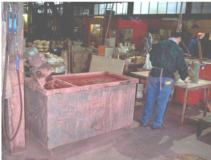
Foto 2.1.12 Vasca di verniciatura delle anime con vernici refrattarie all'acqua, dotata di mescolatore
