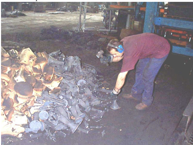
Foto 2.1.25 Rottura manuale delle materozze di pezzi piccoli in una azienda caratterizzata da una produzione limitata
