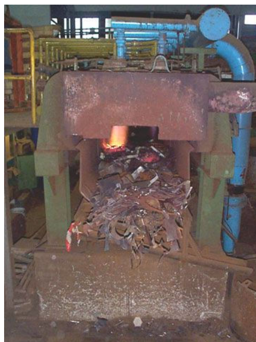
Foto 2.1.16 Forno a gas per il preriscaldamento del rottame
