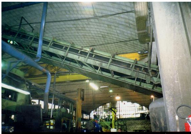
Foto 2.1.4 Impianto a nastro sopraelevato per il trasporto della terra dalla miscelazione alla formatura.
