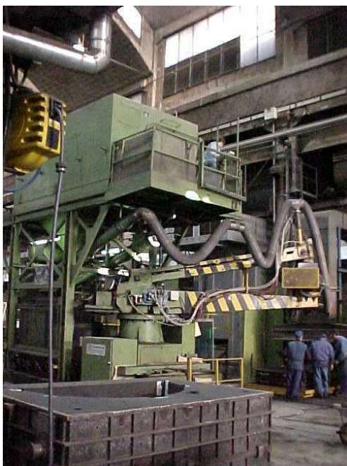
Foto 2.1.7: Carro su rotaia (chiamato in gergo cammello) con braccio mobile per riempimento delle staffe grandi con terra di fonderia nel reparto di formatura manuale (in posizione di scarico nelle staffe, con operatore a bordo).
