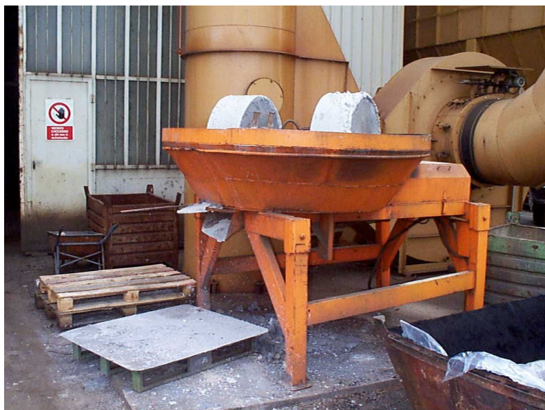
Foto 2.1.21 Molazza per la preparazione della terra refrattaria (macchina con protezioni rimosse).
