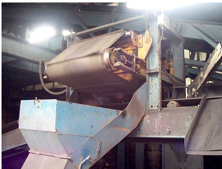
Foto 2.1.5 Deferrizzatore ortogonale al nastro trasportatore con in primo piano lo scivolo di raccolta del metallo.
