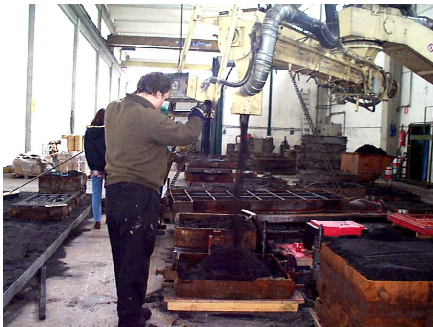
Foto 2.1.8 Riempimento staffe con terra di fonderia nel reparto di formatura manuale con impianto fisso. Si noti il tubo di colore grigio argenteo per l'aspirazione localizzata sulla bocca di uscita della terra dal mescolatore a coclea.
