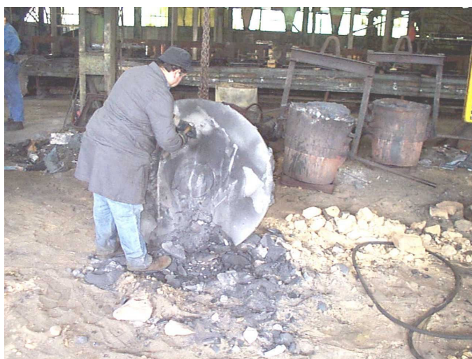
Foto 2.1.23 Disterratura con attrezzi manuali di un getto di grandi dimensioni realizzato tramite colata della lega metallica in una forma realizzata con il processo di formatura manuale in anidride carbonica
