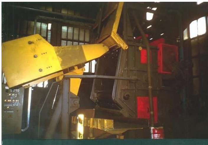
Foto 2.1.26 Sabbiatrice a tappeto durante il caricamento dei getti. Si noti il caricatore automatico a sollevamento pneumatico (a sinistra) ed il coperchio scorrevole aperto (in alto)
