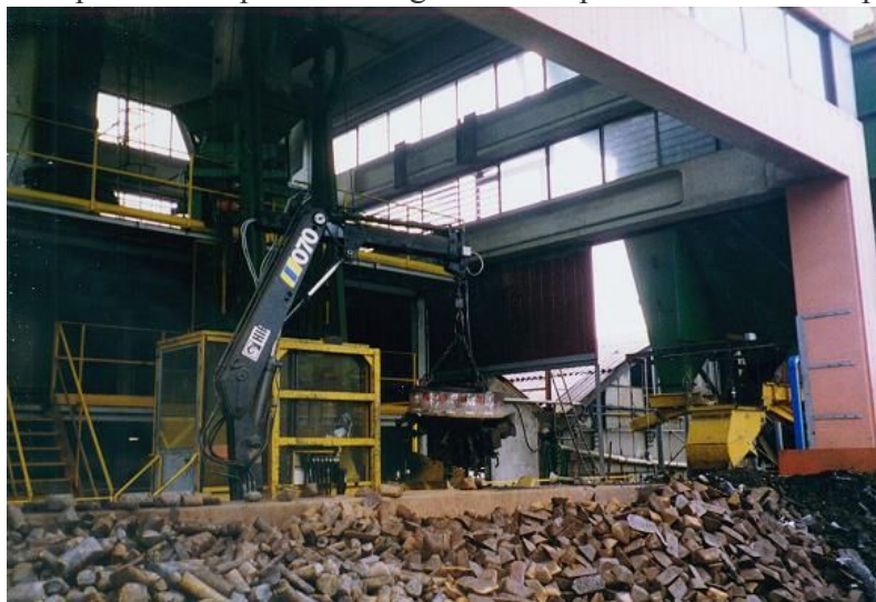
Foto 2.1.15 Impianto di caricamento dei forni con elettromagnete per la presa dei pani di ghisa dal loro deposito. La cabina dell'operatore alla gru è climatizzata.
