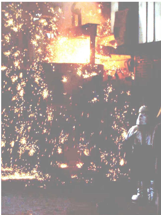
Foto 2.1.20 spillatura del metallo fuso dal forno in siviera di grandi dimensioni.
