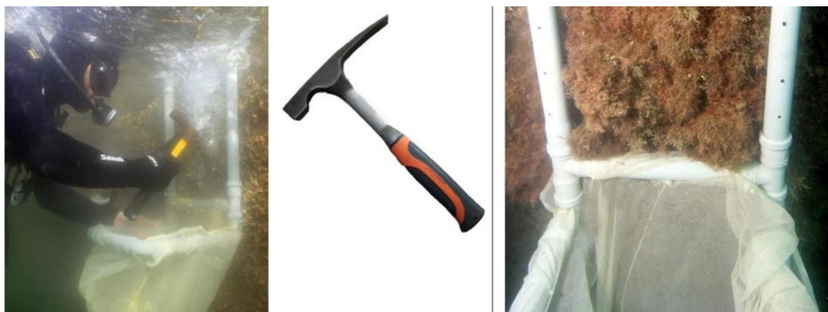
Fig. A 3 - Attività di campionamento subacqueo con scalpello e rettangolo di campionamento.
