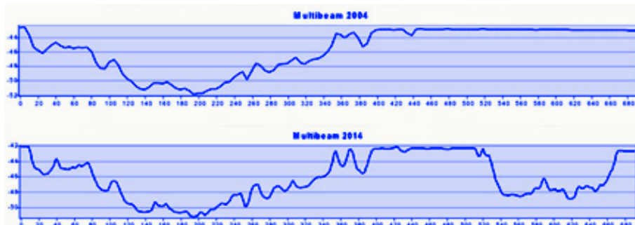
Fig.4 - Confronto tra i rilievi multibeam condotti nel 2004 (risoluzione di 5m) e nel 2015 (risoluzione di 1m), da ISPRA (2015)
