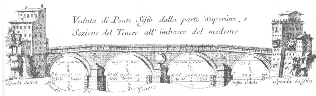
Fig. 6-9 - Ponte Sisto nel XVIII sec., con sezione del fiume Tevere. - An 18th Cent. drawing of Ponte Sisto, with a section of the Tiber river.
