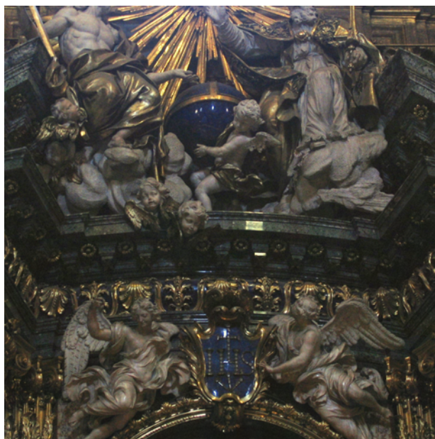
Fig. 7-6 - In alto, sopra un altare della Chiesa del Gesù, la "palla di lapislazzuli", in realtà una sfera di tufo dipinta. - The "lapislazul ball" of an altar of the Chiesa del Gesù, a painted tuff sphere.
