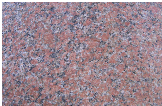
Fig. I-2 - Grana fine del granito di Aswan usata per gli obelischi. - Fine-grained Aswan granite of the obelisks.
