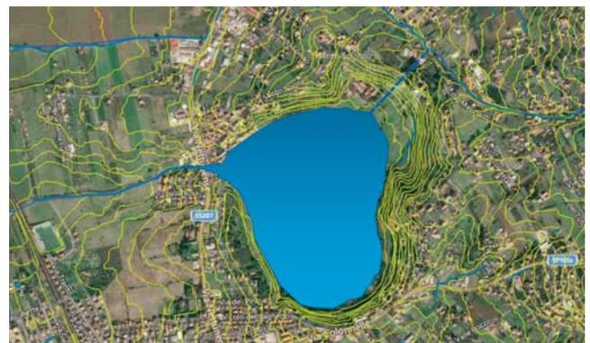
Fig. 11 - Modello di simulazione della tracimazione del Lago di Giuturna nel caso in cui il livello delle acque superasse l'isoipsa dei 196m - in blu l'idrografia, a tratteggio blu il canale immissario sotterraneo ed in giallo le curve di livello. Immagine di base Bigs Maps 2019. Si confronti con la Fig. 2.
