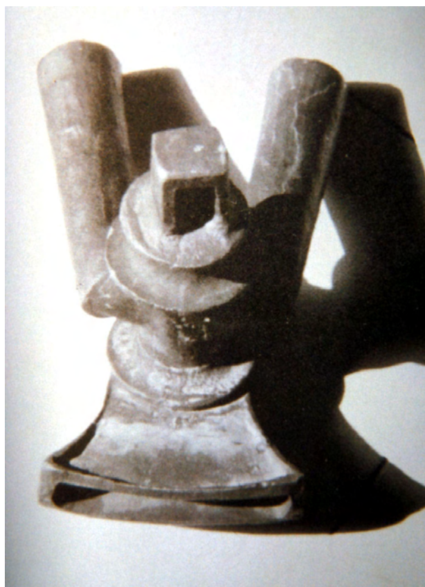
Fig. 29 - Valvola per la miscelazione di acqua calda e fredda. - Mixer tap for cold and hot water.
