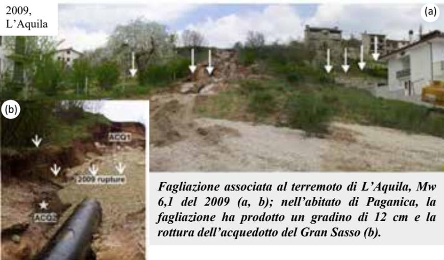
**Fagliazione associata al terremoto di L'Aquila, Mw 6,1 del 2009 (a, b); nell'abitato di Paganica, la fagliazione ha prodotto un gradino di 12 cm e la rottura dell'acquedotto del Gran Sasso (b).**
