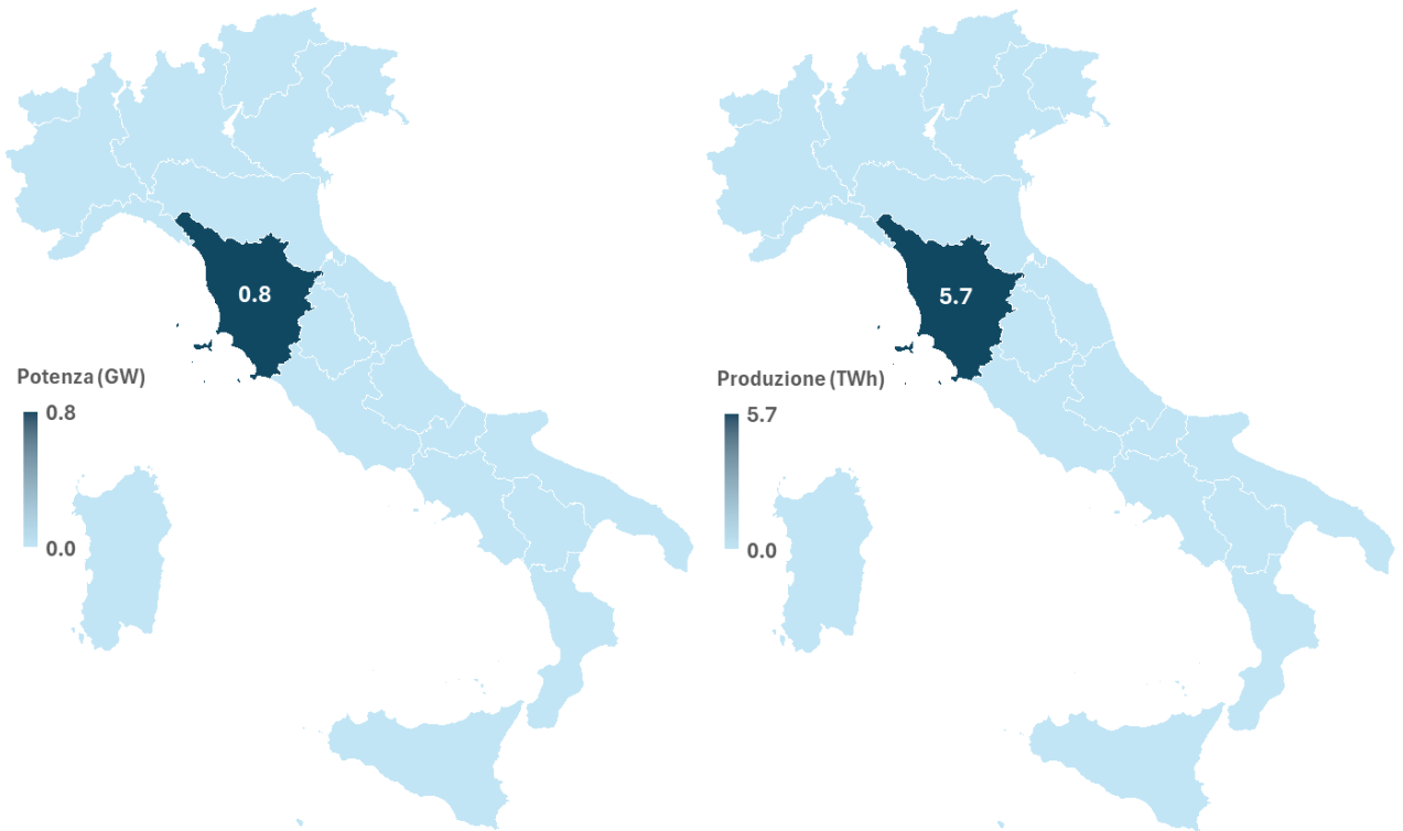
Figura 1.18 – Mappe regionali della potenza efficiente e della produzione elettrica lorda da impianti geotermici nel 2024.
