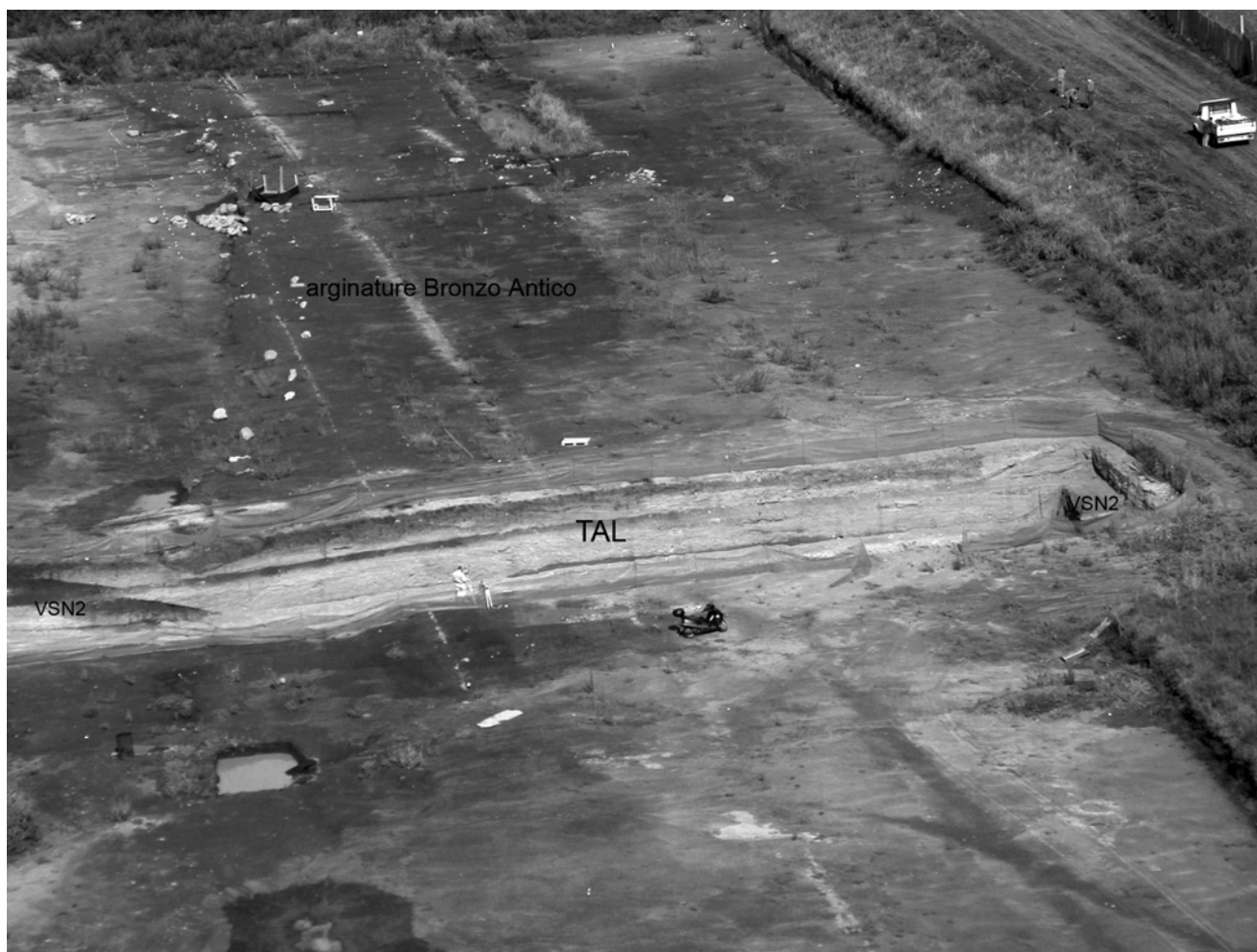
Fig 21 - Trincea scavata in località Lucrezia Romana (via delle Capannelle) attraverso una delle paleovalle würmiane scavate nell'unità di Villa Senni e colmate dalla formazione del Tavolato, visibile in grigio al di sopra di un paleosuolo marrone. Da notare al tetto della formazione la presenza di arginature dell'epoca del Bronzo, relative ai primi insediamenti protostorici nell'area avvenuti dopo l'ultima attività da lahar.
