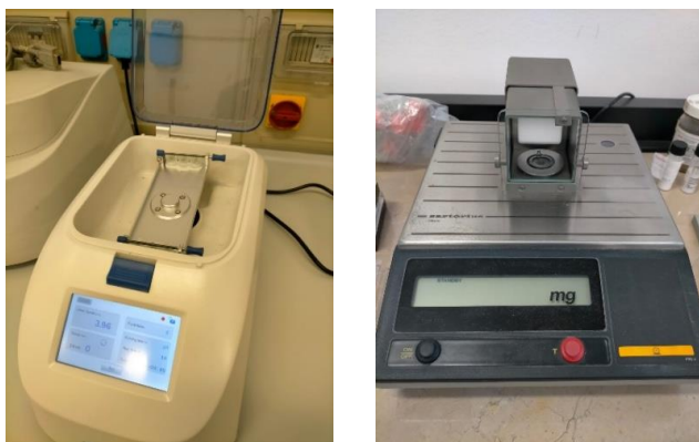
Fig 2.3 – Strumentazione EA-IRMS: a sinistra Delta V Isotope Ratio Mass Spectrometer; a destra l'analizzatore elementare CHN Flash 2000
