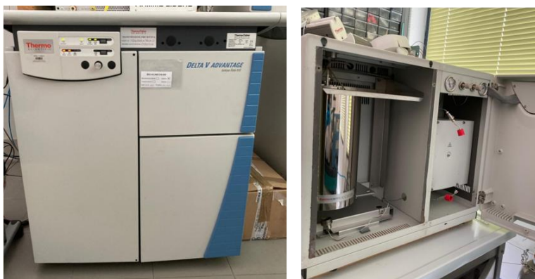
Fig 2.3 – Strumentazione EA-IRMS: a sinistra Delta V Isotope Ratio Mass Spectrometer; a destra l'analizzatore elementare CHN Flash 2000
