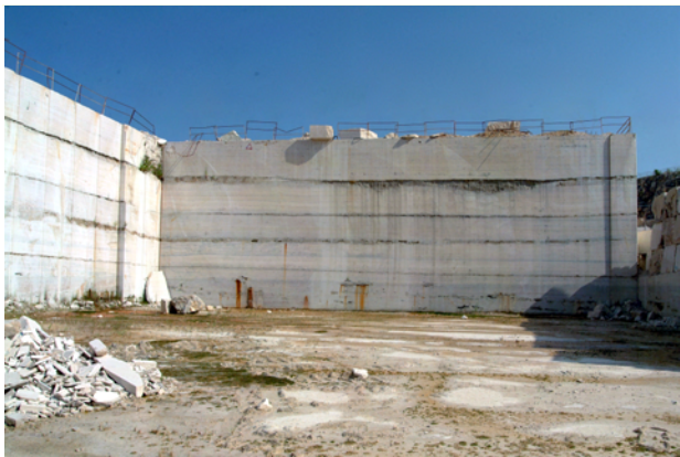
Fig. F-2 - Il fronte di una cava di travertino, con evidenti le discontinuità orizzontali, dovute a livelli di suoli sviluppatisi durante hiatus di sedimentazione (foto R. LUCIANI). - The front of a travertine quarry, showing the horizontal discontinuities due to soil development during sedimentation hiatus (photo by R. LUCIANI).
