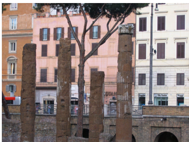
Fig. B-5 - Colonne di Tufo Lionato in parte intonacate, nell'Area Sacra di Largo Argentina. - Columns of Tufo Lionato in the Area Sacra of Largo Argentina, with remains of a plaster cover.
