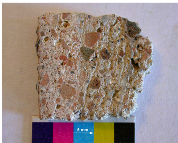
Fig. 3-2 - Intonaco di cisterna romana con evidenti i clasti di cocciopesto e la malta pozzolanica.
