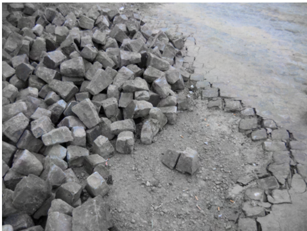
Fig. A-6 - Un mucchio di sampietrini, blocchi di pavimentazione di forma tronco-piramidale, allettati su una base di sabbia. - A heap of "sampietrini", truncated pyramidal lava paving blocks, on a sandy foundation..
