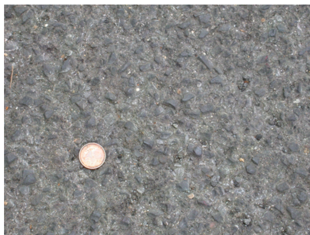
Fig. A-8 - Agglomerato bituminoso con granulato di materiale lavico. - Bituminous aggregate with lava clasts as filler.
