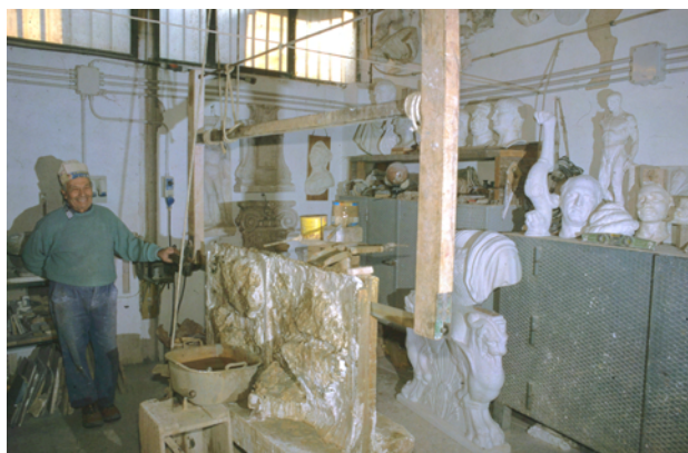
Fig. D-6 - Ancora oggi i marmorari romani utilizzano i medesimi strumenti conosciuti in antico; in primo piano un telaio per il taglio di blocchi o colonne (atelier G. De Tomassi).
