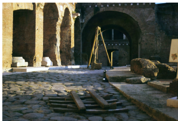
Fig. D-3 - Macchine (lizza e capra) usate dalle maestranze per la produzione di marmi, in mostra sul basolato della Biberatica ai Mercati di Traiano.
